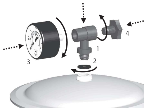
Montage van de manometer (met ontluuchting)
